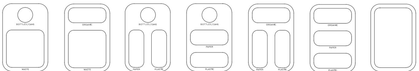
**Breite** 340 mm, 12,6" | **Höhe** 300 mm, 11,8" | **Tiefe** 230 mm, 9,1" | **Rahmen** 1 mm pulverbeschichtetes Blech | **Deckel** 1,5 mm pulverbeschichtetes Blech
